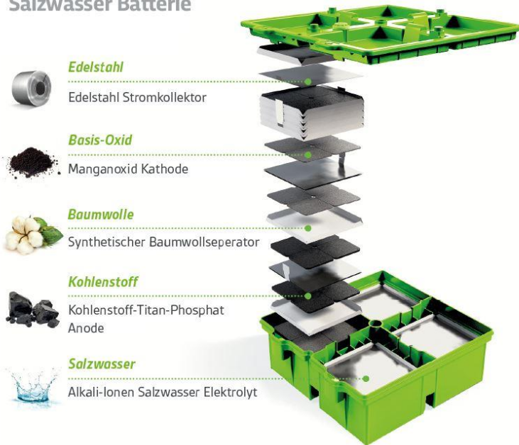
Bild 1: Der Aufbau der Salzwasserbatterie zeigt, dass sie durchgehend aus nachhaltigen und ungiftigen Materialien besteht.
