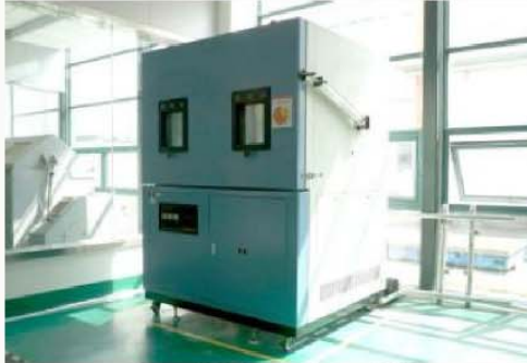
Sand & Dust Test(IEC 60529:2001)
